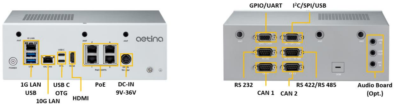
Figure 2.1 AIE-KX11/AIE-KX12/AIE-KX21/AIE-KX22 I/O Interface
